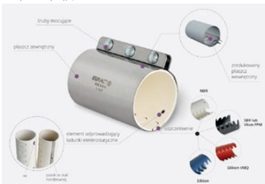
FOT. 2 Elementy składowe złączki typu „M”
