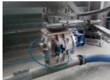
FOT. 5 Dozownik celkowy grawitacyjny RVC, stosowany w przetwórstwie i recyklingu tworzyw sztucznych
