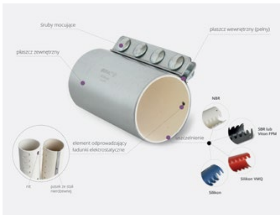
FOT. 4 Elementy składowe złączki typu „H”
