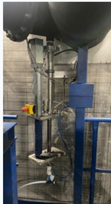
FOT. 4. Przykład montażu próbobiornika
