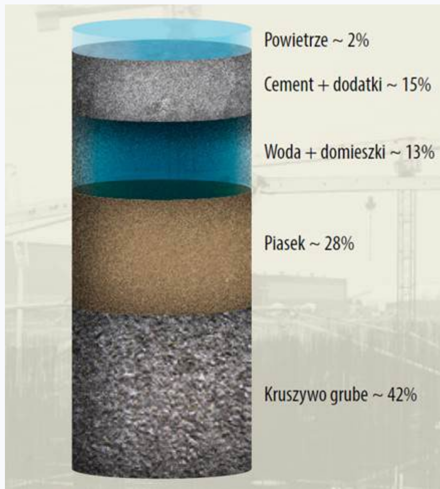
RYS. 1 Objętościowy skład betonu
