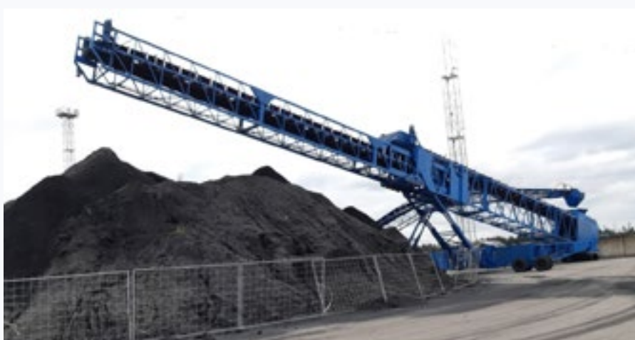
FOT. 2, 3 Ciężki przenośnik samobieżny: w trakcie przejazdu (u góry) oraz gotowy do pracy (na dole)
