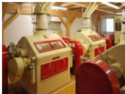
FOT. 7 Mlewniki walcowe w Zechlesmühle an der Glems w Niemczech [ŹRÓDŁO: Wikipedia, Harke, CC BY-SA 3.0]
