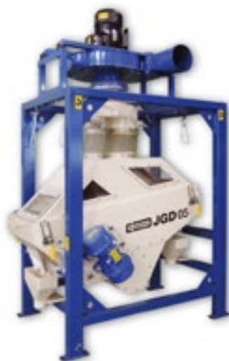
FOT. 4 Przeznaczony do oddzielania kamieni, dzielenia materiału na frakcje lekkie i ciężkie oddzielacz kamieni JGD 05 [ŹRÓDŁO: POLnet]
