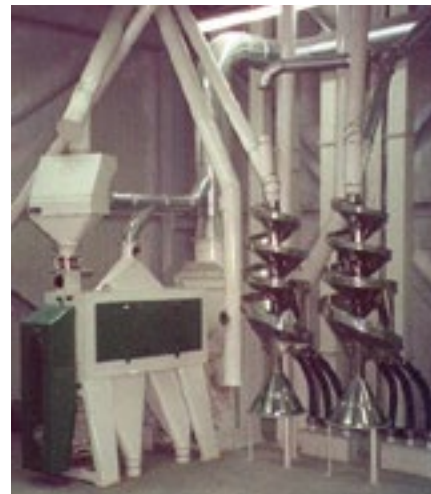
FOT. 6 Żmijka nazywana też celenderem do oczyszczania zboża [ŹRÓDŁO: Centrum Doradztwa Rolniczego w Brwinowie]
