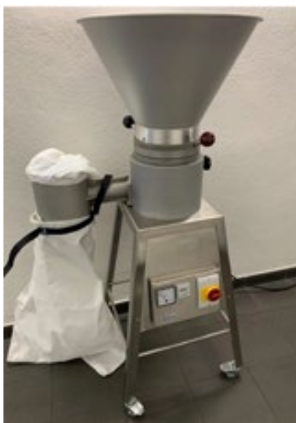
FOT. 8 Przemysłowy mlewnik żarnowy do zboża Schnitzer PIE 380 [ŹRÓDŁO: Niro Bio]
