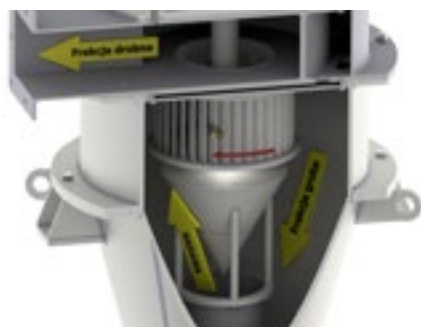
RYS. 1 Proces separacji wewnątrz klasyfikatora z głównymi siłami działającymi na cząstkę
