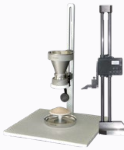
FOT. 3 Komora zasypowa do ręcznego testu kąta usypu Electrolab EFT-01
