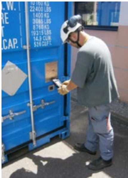
FOT. 7 Odczyt danych RFID z kontenera [ŹRÓDŁO: Nexess Solutions]
