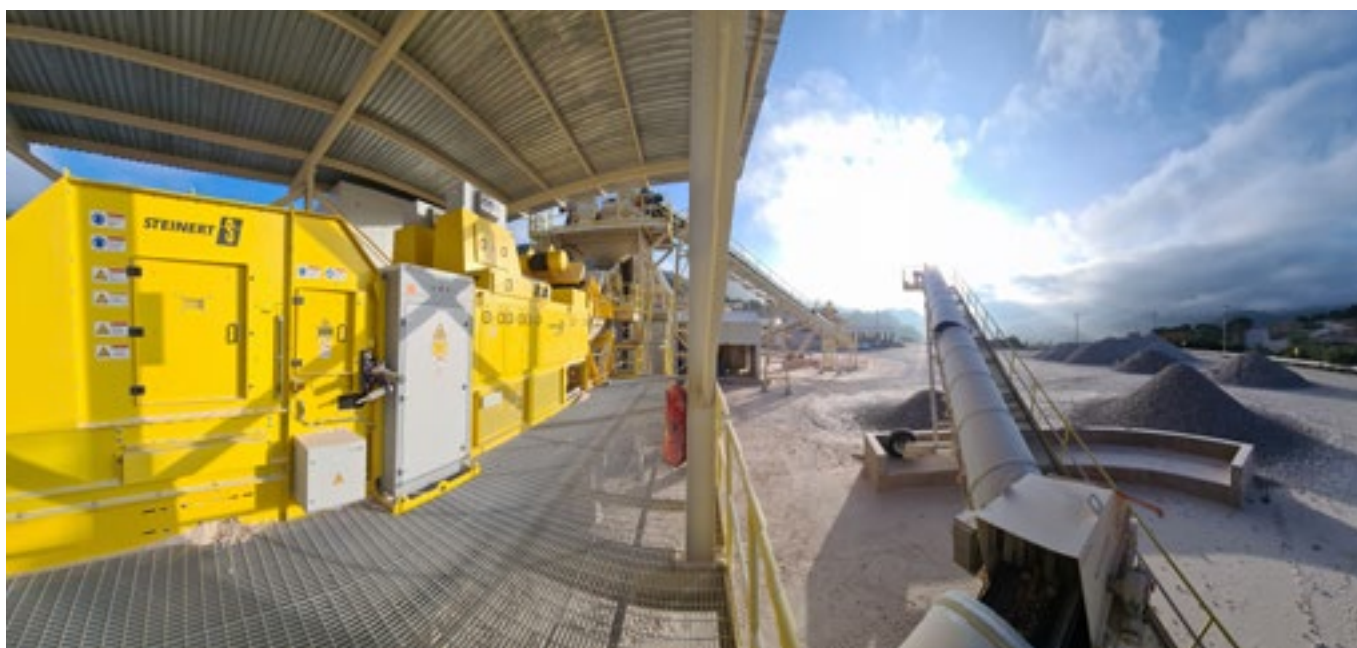
FOT. 1 Czujnikowy system sortowania nie wymaga wody. Ułatwia to korzystanie z takiej maszyny w trudnych warunkach pogodowych, a także pozwala na uniknięcie szkód środowiskowych.
