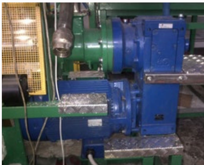
FOT. 2 Motoreduktor w wykonaniu wydłużonym zastosowany w układzie plastyfikującym
