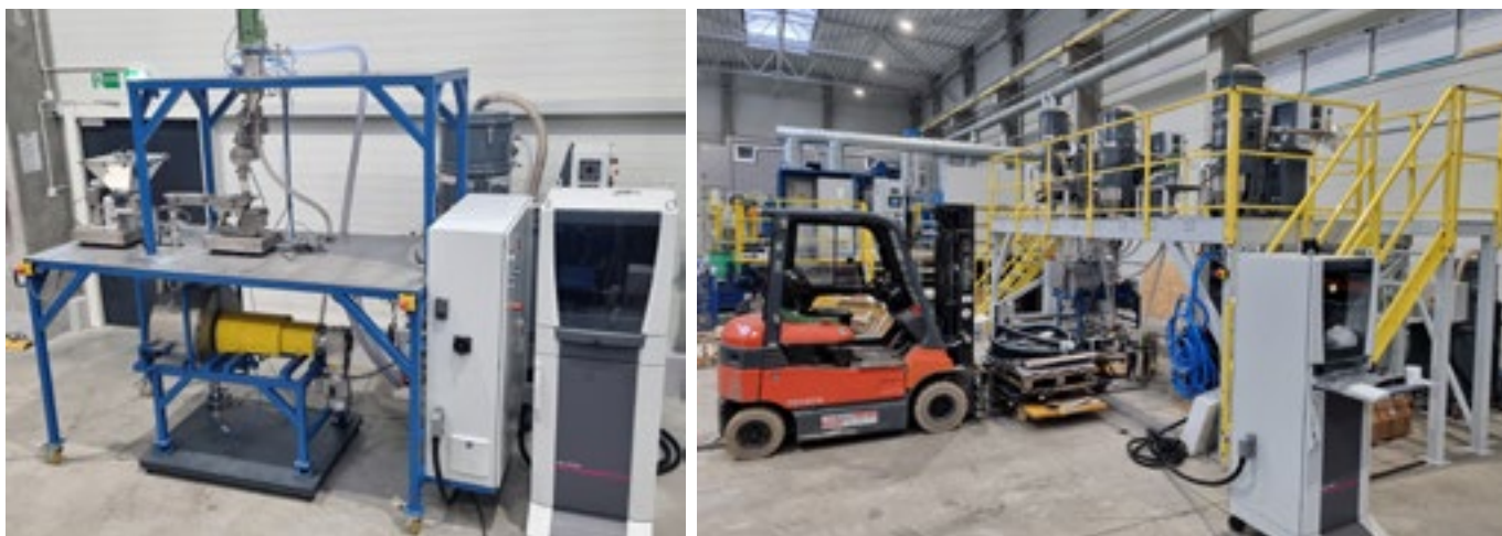
FOT. 5, 6 Pilotażowy system mielenia kulowego BMX-400 (po lewej) i BMX-500 (po prawej) [ŹRÓDŁO: COMEX POLSKA]
