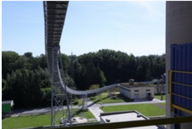
FOT. 6 Przenośniki z taśmą w kształcie litery U można łatwo zintegrować i nadają się również do poziomych i pionowych łuków.
