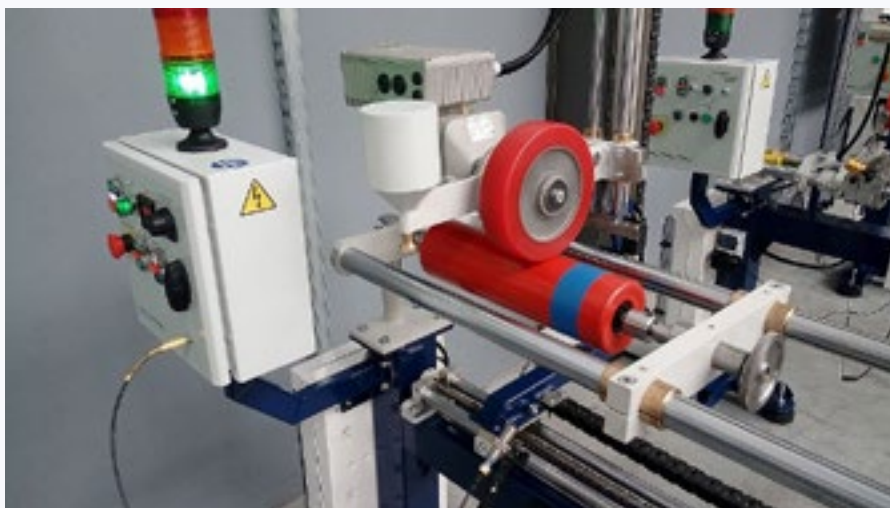
FOT. 1 Laboratoryjny system badania przesuwu osiowego i zużycia powłok krążników – InterKraj
