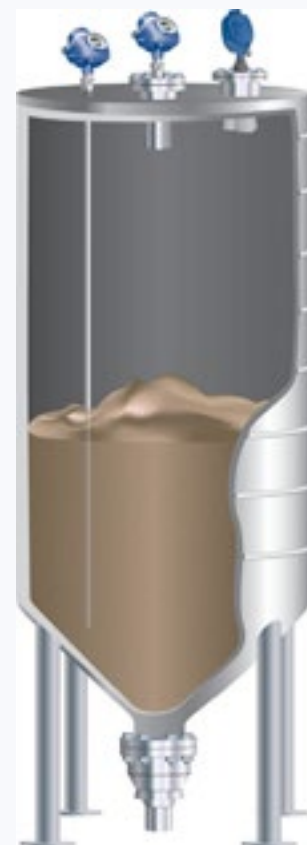
RYS. 2 Zbiornik z trzema technologiami pomiarowymi – od lewej: sensor radarowy z falowodem, sensor radarowy i sensor ultradźwiękowy [ŹRÓDŁO: Emerson Process Management]
