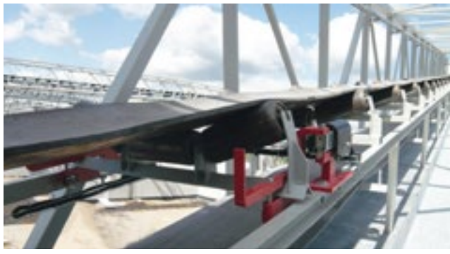
FOT. 3 Taśmociąg z systemem ważenia [ŹRÓDŁO: Siemens]
