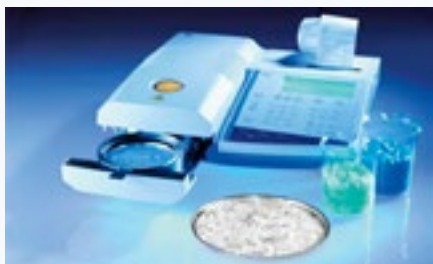
FOT. 1 Halogenowy analizator wilgoci HR 83 automatycznie waży a następnie podgrzewa położoną na szalce próbkę polimeru
