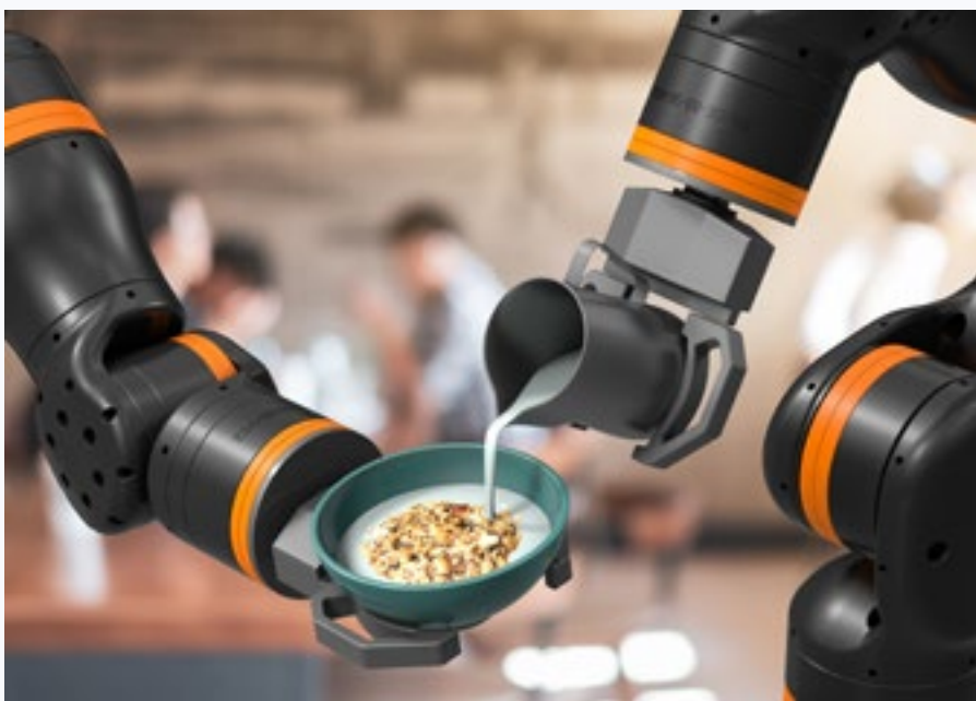
FOT. 1 Ekonomiczny, lekki i łatwy we współpracy człowiek-robot: nowy igus ReBeL z polimerową przekładnią. (źródło: igus GmbH)
