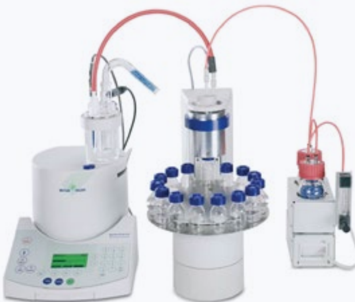
FOT. 2 System DL39 firmy Mettler Toledo do w pełni zautomatyzowanego oznaczania zawartości wody metodą Karla Fischera wraz z zestawem osuszającym i dodatkową pompą powietrzną [ŹRÓDŁO: Mettler Toledo]
