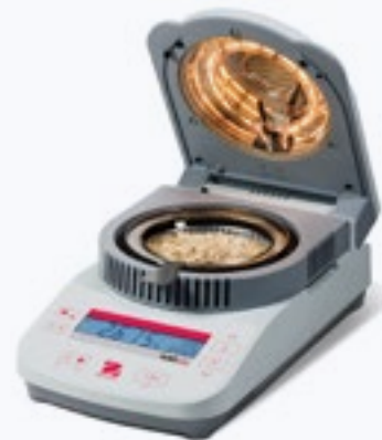
FOT. 4 Wagosuszarki to najczęściej wykorzystywany w warunkach przemysłowych sprzęt pozwalający zmierzyć wilgotność sypkich próbek – na zdjęciu Ohaus MB25 [ŹRÓDŁO: Ohaus]
