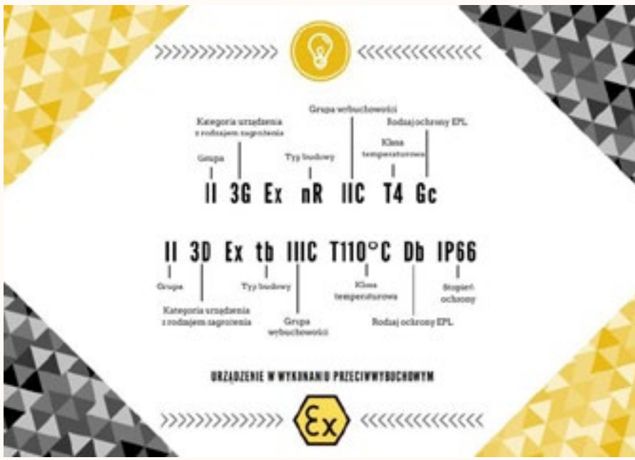
RYS. 1 Oznaczenia sprzętu przystosowanego do pracy w strefach Ex [4]
