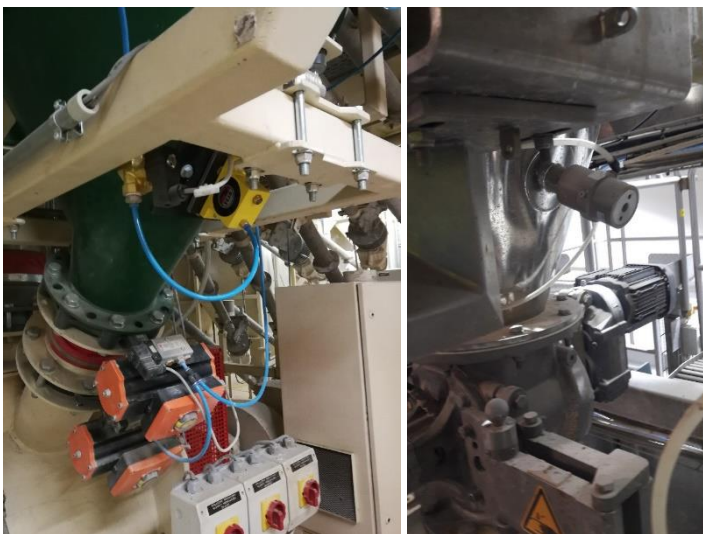
FOT. 9, 10 Do stref HT firma „INWET” poleca też bardzo popularne wibratory pneumatyczne (temp. pracy otoczenia do 150°C)
