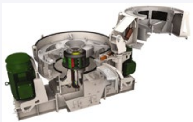
RYS. 2 Kruszarka uderzeniowa z wałem pionowym nazywana kubizem VSI (Vertical Shaft Impact) Barmac seria B [ZŹRÓDŁO: Metso]
