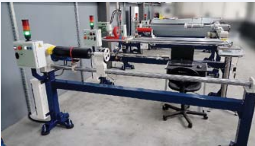
FOT. 4 Kontrola oporów obracania się krążnika – InterKraż
