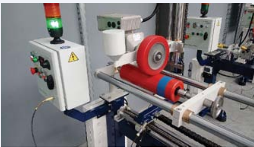
FOT. 3 Laboratoryjny system badania przesuwu osiowego i zużycia powłok krążników – InterKraż
