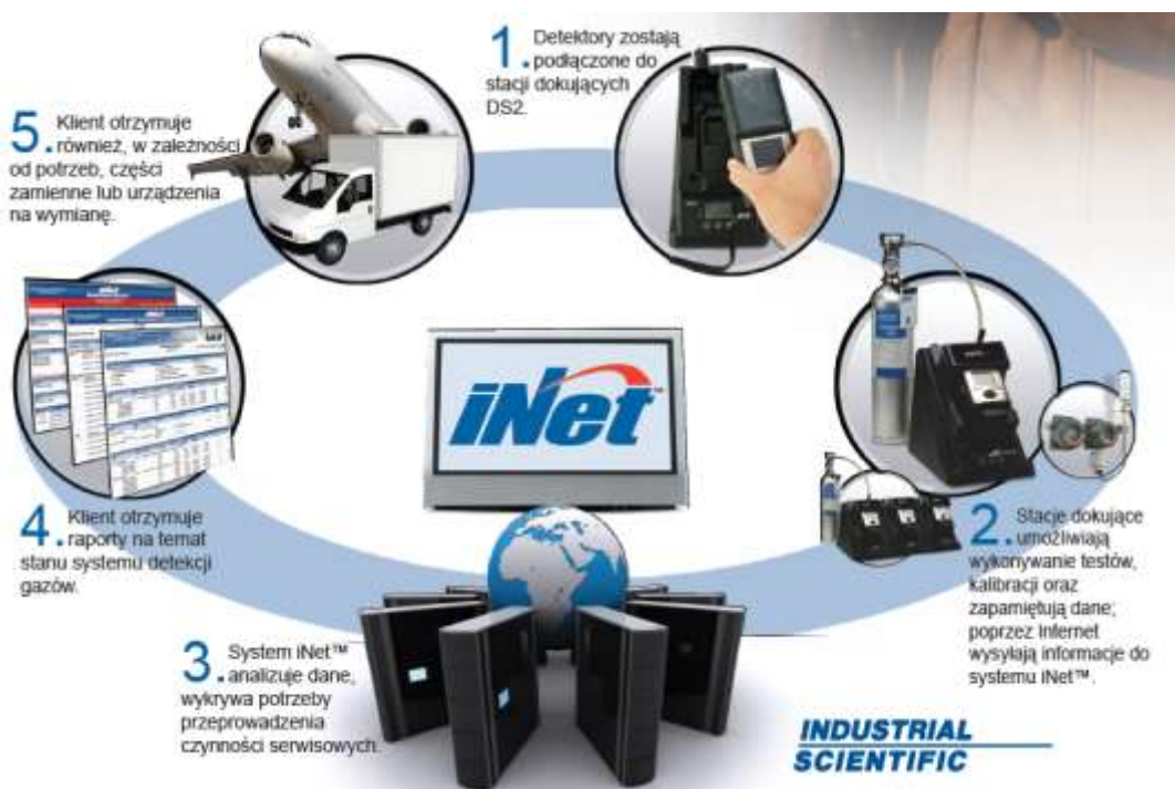
RYS. 1. Zasada działania systemu iNet
