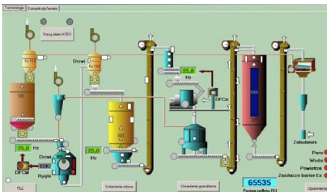
RYS. 3 Ekran synoptyczny sterowania – instalacja do peletu
