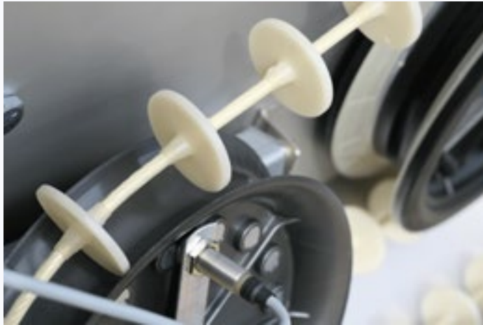
FOT. 5 Talerzyki w przenośniku linowo-rurowym przymocowane do ciągną w postaci liny [ZŹRÓDŁO: Wessjohann]
