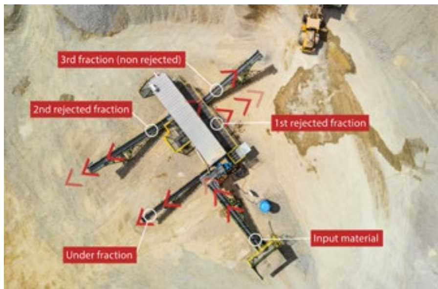
FOT. 1 Schemat instalacji OCXR-1000-3F
