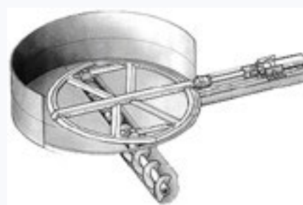
FOT. 3 Rami poślizgowe projektowane są do silosów o średnicy dna od 2,5 m do 12 m i przy pojemności od 5 m³ do 2500 m³ [Źródło: EST]
