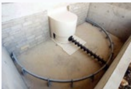
FOT. 1 Ukośny wygarniacz ślimakowy [Źródło: Fortech]
