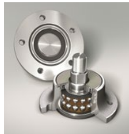
FOT. 3 Piasty Agro NSK, wyposażone w solidne łożyska kulkowe skośne przenoszące duże siły osiowe i przechylające, posiadają skuteczne uszczelnienie i połączenie kołnierzowe do bezpośredniego montażu na maszynie.
