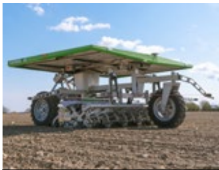
FOT. 1 Ekologiczny i neutralny pod względem emisji CO 2 automatyczny robot do odchwaszczania i siewu FarmDroid FD20 na stoisku NSK na targach Agritechnica. (Źródło: FarmDroid)
