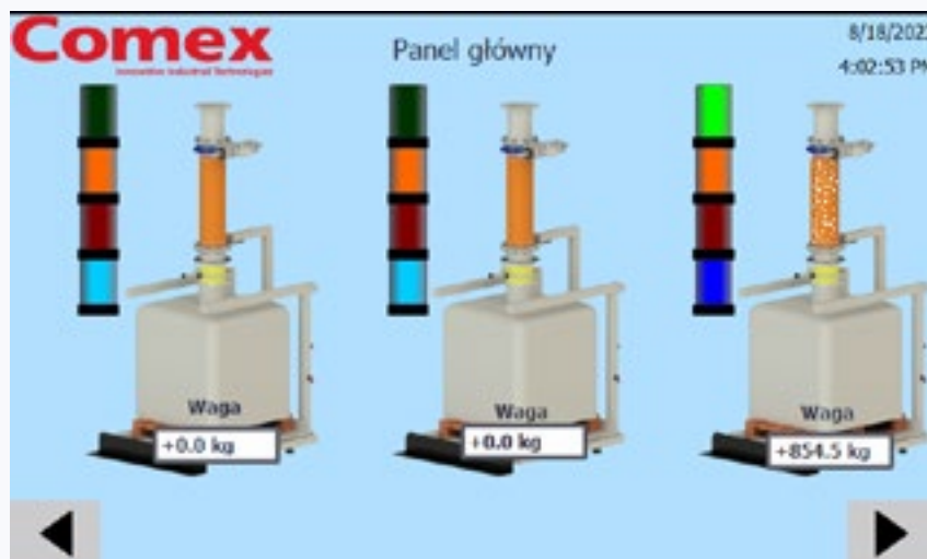
FOT. 4 Panel główny systemu ADWS-200/3
