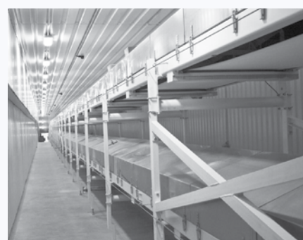
FOT. 3 Urządzenia transportowe w silosie na cukier: a) obudowany przenośnik kubelkowy we wnętrzu transportowej, b) obudowany przenośnik ślimakowy w galerii transportowej [Chemadex S.A.]
