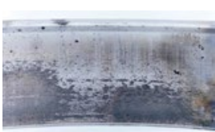
RYS. 3 Wyrwy powstałe na skutek zmęczenia materiału.
