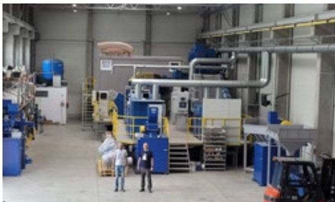
FOT. 5 Układ walidacyjny separacji optycznej i rentgenowskiej
