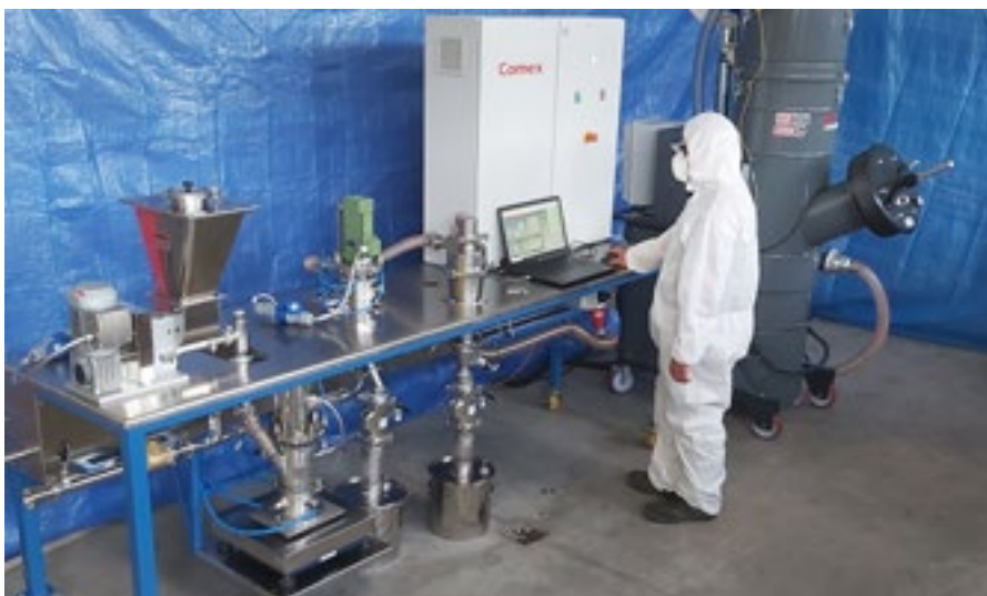
FOT. 2 Zminiaturyzowany laboratoryjny system do klasyfikacji aerodynamicznej i mielenia strumieniowego
