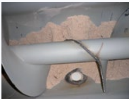
RYS. 2 Kontaktowy czujnik wilgotności trocin we wnętrzu przenośnika ślimakowego
