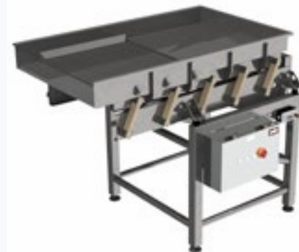
FOT. 4 Podajnik wibracyjny dwumasowy napędzany elektrowibratorami – do podawania owoców na sorter optyczny
