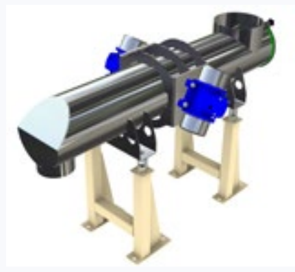
FOT. 2 Podajnik wibracyjny rurowy napędzany elektrowibratorami – do podawania kawy mielonej
