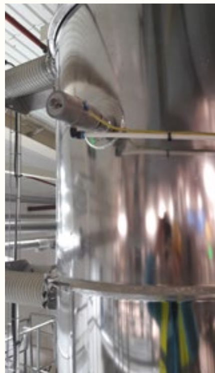
FOT. 5 Do stref ATEX firma „INWET” poleca też bardzo popularny wibrator FPLF EX (na górze zdjęcia)
