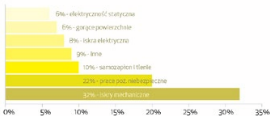
RYS 1 Źródła zapłonu atmosfer wybuchowych – statystyki na podstawie danych z 2000 wybuchów w przemyśle na podstawie Dust explosions: A threat to the process industries (Zhi Yuana, Nima Khakzad, Faisal Khana, Paul Amyotte)
