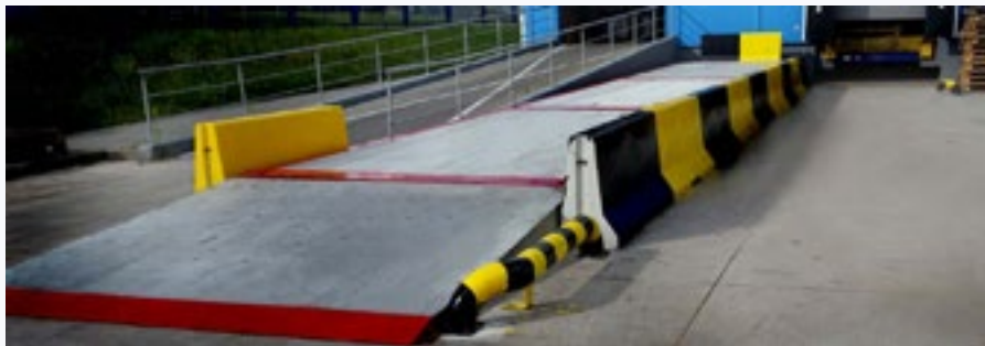
FOT. 3 Najazdowa waga samochodowa [źródło: Wagi Bydgoszcz]
