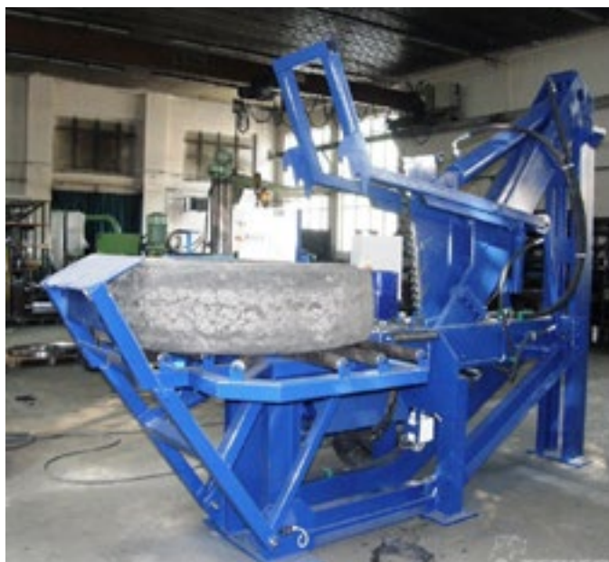
FOT. 8 Recykling opon, wyskubywarka [ŹRÓDŁO: Terier.cz]
