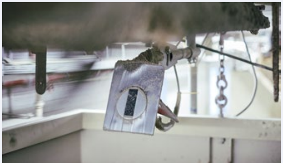
FOT. 2 Czujnik radarowy do pomiaru wilgotności Solitrend MMP41 (przykład zastosowania)
