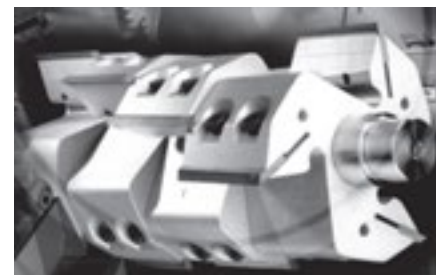
FOT. 6 Wirnik z nożami segmentowymi
