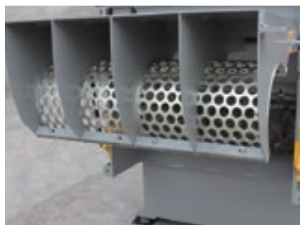
FOT. 5 Sito ustalające wielkość mielonego materiału [ŹRÓDŁO: www.wartacz.com.pl]
