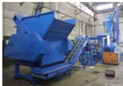
FOT. 9 Linia do recyklingu kabli i wiązek samochodowych – separator [ŹRÓDŁO: Terier.cz]
