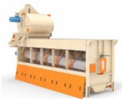
FOT. 2 Separator bębnowy (trier) do zboża o wydajności 50 t na godzinę [ŹRÓDŁO Vi-Agro]
