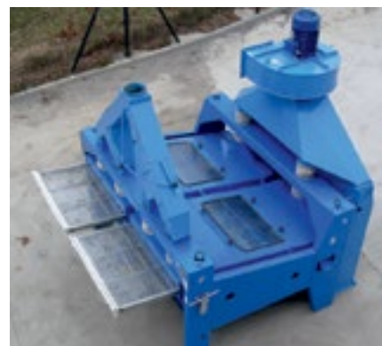
FOT. 3 Separator-czyszczalnia do zboża PAT BCX-100 o wydajności od 40 do 80 t na godzinę [ŹRÓDŁO: PAT Chomutów]
