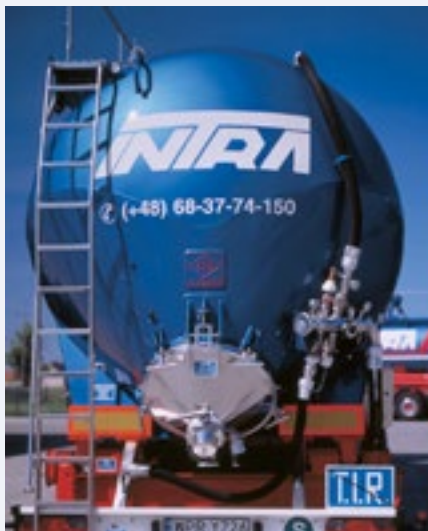
FOT. 8 Tylony stożek rozładunkowy silosu podnoszonego [Zrędko: CEMET]
