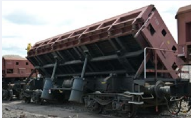
FOT. 9 Czteroosiowy wagon samowyladowczy model 418 V, przeznaczony do przewożenia materiałów sypkich o masie usypowej 1,5–2,5 t na m 3 , np. piasku, żwiru, tłuczni, ziemi [Zrędko: Grupa ZUE]
