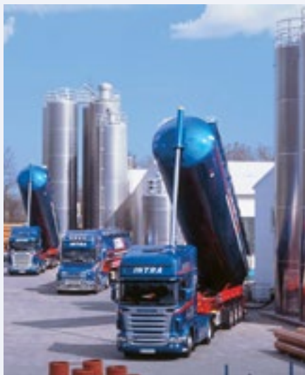
FOT. 7 Silos podnoszony [Zrędko: Intra]
