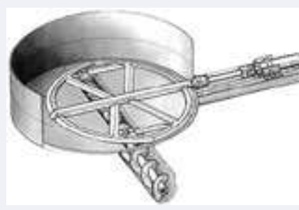
FOT. 3 Ramy poślizgowe projektowane są do silosów o średnicy dna od 2,5 m do 12 m i przy pojemności od 5 m³ do 2500 m³ [ŹRÓDŁO: EST]
