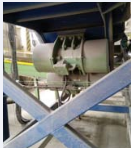
Zespół kruszarki z podajnikiem wibracyjnym napędzanym silnikami wibracyjnymi marki Friedrich typu F 600-6-3.4 – instalacja do recyklingu szkła
