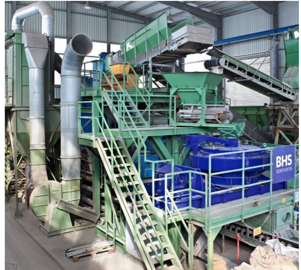
Układ kruszernia z kruszarką RPMX firmy BHS-Sonthofen
