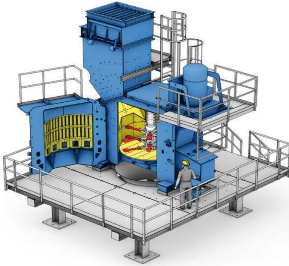
Kruszarka prętowa typu RS z wirnikiem pionowym firmy BHS-Sonthofen
