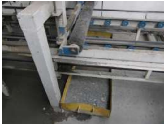
Stanowisko szczotkowania przed montażem osłony i układu odsysającego pyłu (ŹRÓDŁO ILUSTRACJI: Bart Sp. z o.o.)
