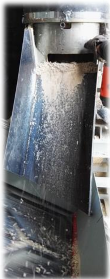
Rys 7. Przemysłowy granulator z matrycą płaską
