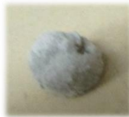
Rys 15. Granulat po przejściu przez granulator talerzowy
