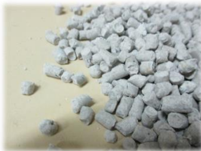
Rys 8. Nawóz wytworzony przy użyciu granulatora walcowego z matrycą płaską
