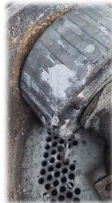
Rys 9. Układ roboczy granulatora
